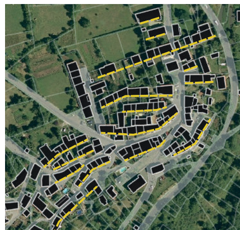
Exemple du village de Nadaillat avec des implantations bioclimatique «avant l'heure», adaptées aux vents dominants et à l'ensolleillement
