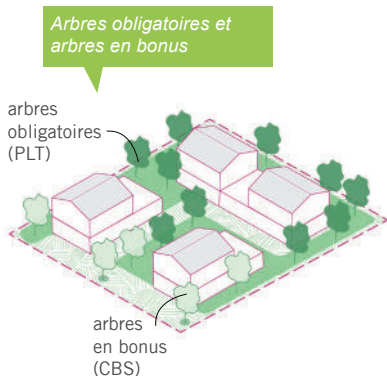
exemple : un projet avec 1000m 2 de PLT. Soit 10 arbres obligatoires. Les 5 arbres supplémentaires peuvent être intégrés au calcul du CBS
